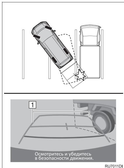
► 1 Направляющие линии ширины автомобиля
