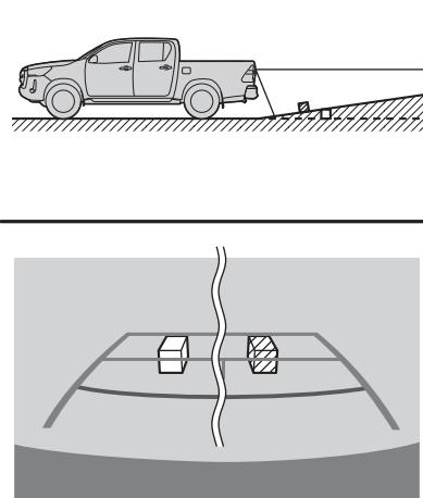
■ **Если поверхность дороги за автомобилем резко опускается вниз**
