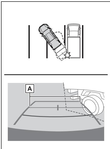
**A** Направляющие линии ширины автомобиля
