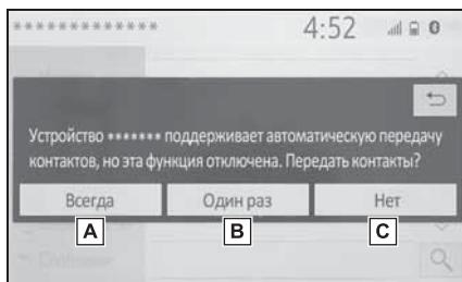
**A** Выберите для автоматической передачи всех контактов из подключенного мобильного телефона.
