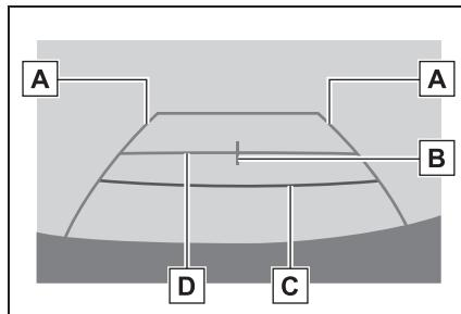
**A Направляющая линия ширины автомобиля**
