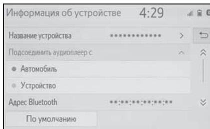
“Автомобиль”: выберите для подключения аудиоплеера из аудио/визуальной системы автомобиля.
