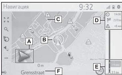
**A** Отображается расстояние до следующего поворота и стрелка, обозначающая направление поворота.
