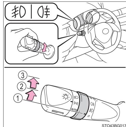
При отпускании кольца выключателя оно возвращается в положение ⚡.
