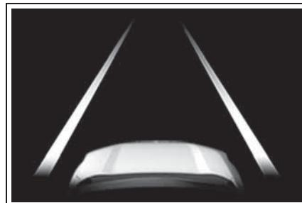
Указывает на то, что система распознает белые (желтые) линии или курс \* . При выходе автомобиля за пределы полосы линия полосы на экране с той стороны, в которую отклоняется автомобиль, будет мигать оранжевым.
