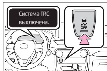
На многофункциональном дисплее отображается символ "Система TRC выключена."
