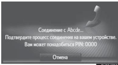
**3** Выполните сопряжение устройства с интерфейсом Bluetooth® с помощью вашего устройства с интерфейсом Bluetooth®.
