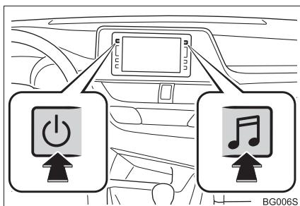
Кнопка питания: Нажмите на эту кнопку, чтобы включить и выключить аудиосистему. Система включается в последнем использовавшемся режиме.
